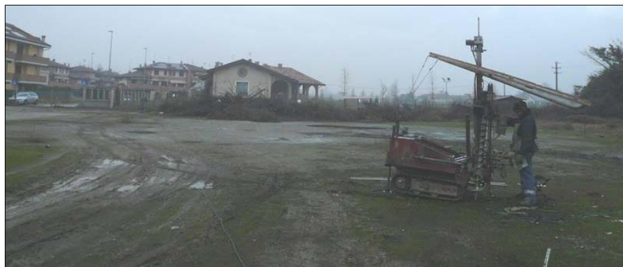
Foto 8-Prova penetrometrica dinamica SCPT3
