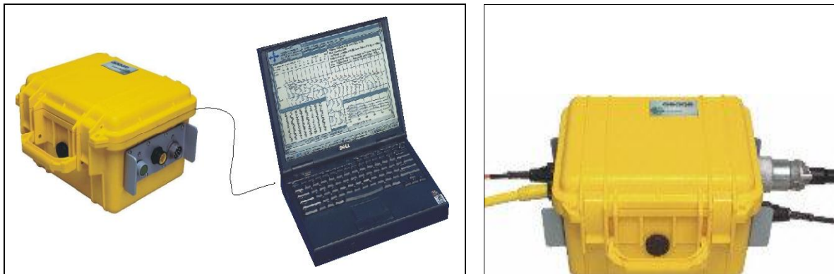
Foto 2-Sismografo geode collegato al pc in acquisizione durante la prova sismica Masw/Re.mi.
