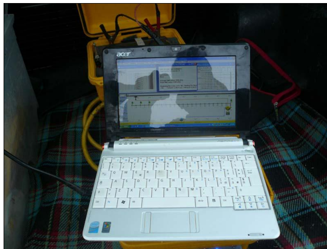
Foto 2-Sismografo geode collegato al pc in acquisizione durante la prova sismica Masw/Re.mi.
