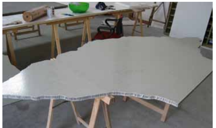
Restauro dello stacco in laboratorio. Preparazione della sagoma del nuovo supporto alveolare per stacchi d'affresco
