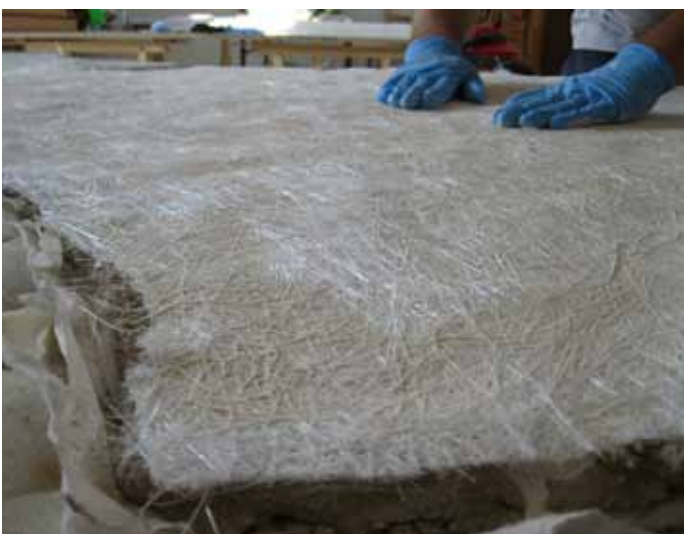
Restauro dello stacco in laboratorio. Stesura di tela in fibra di vetroresina di rinforzo sul retro del frammento. Successivamente lo stacco d'affresco è stato ancorato al nuovo supporto alveolare e riportato nella cappella.
