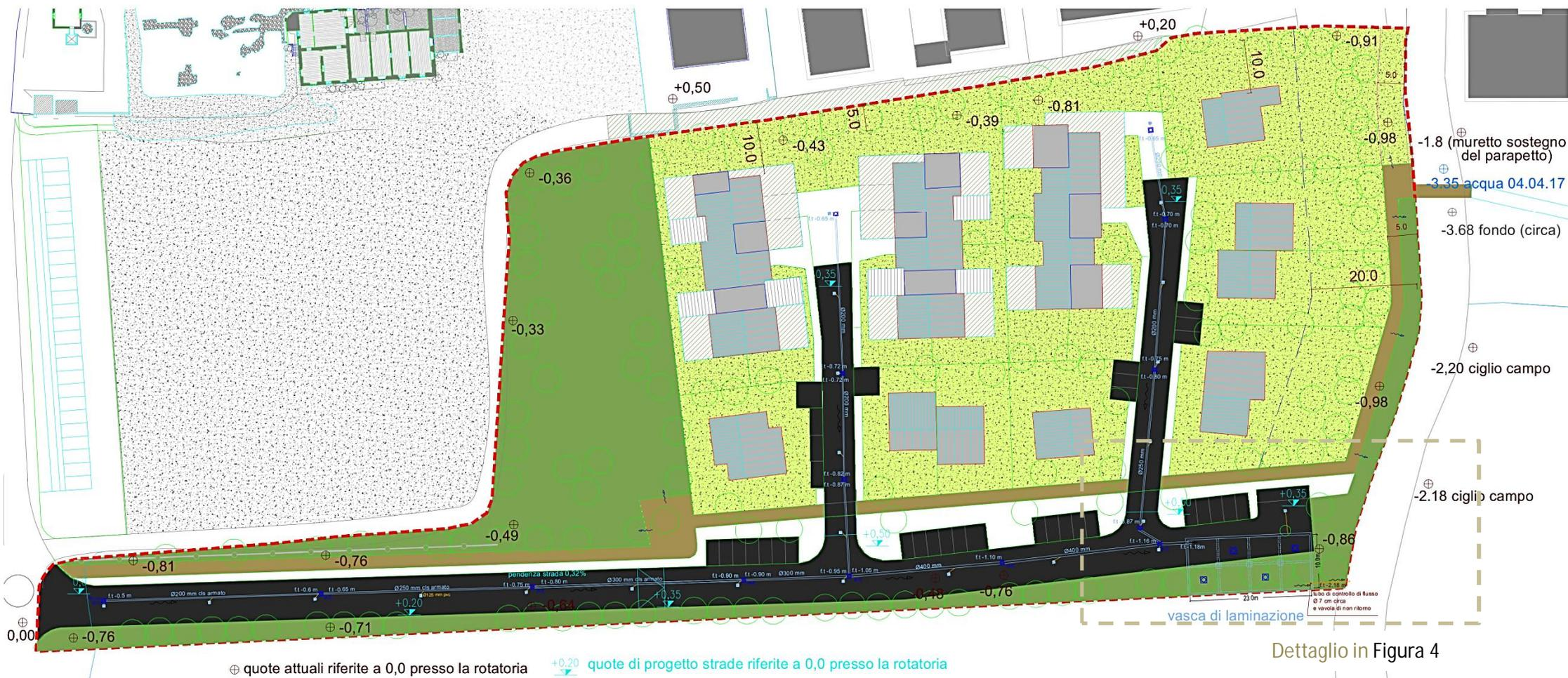
Figura 3: planimetria fognatura acque bianche con vasca di laminazione. Scala 1:1000.
