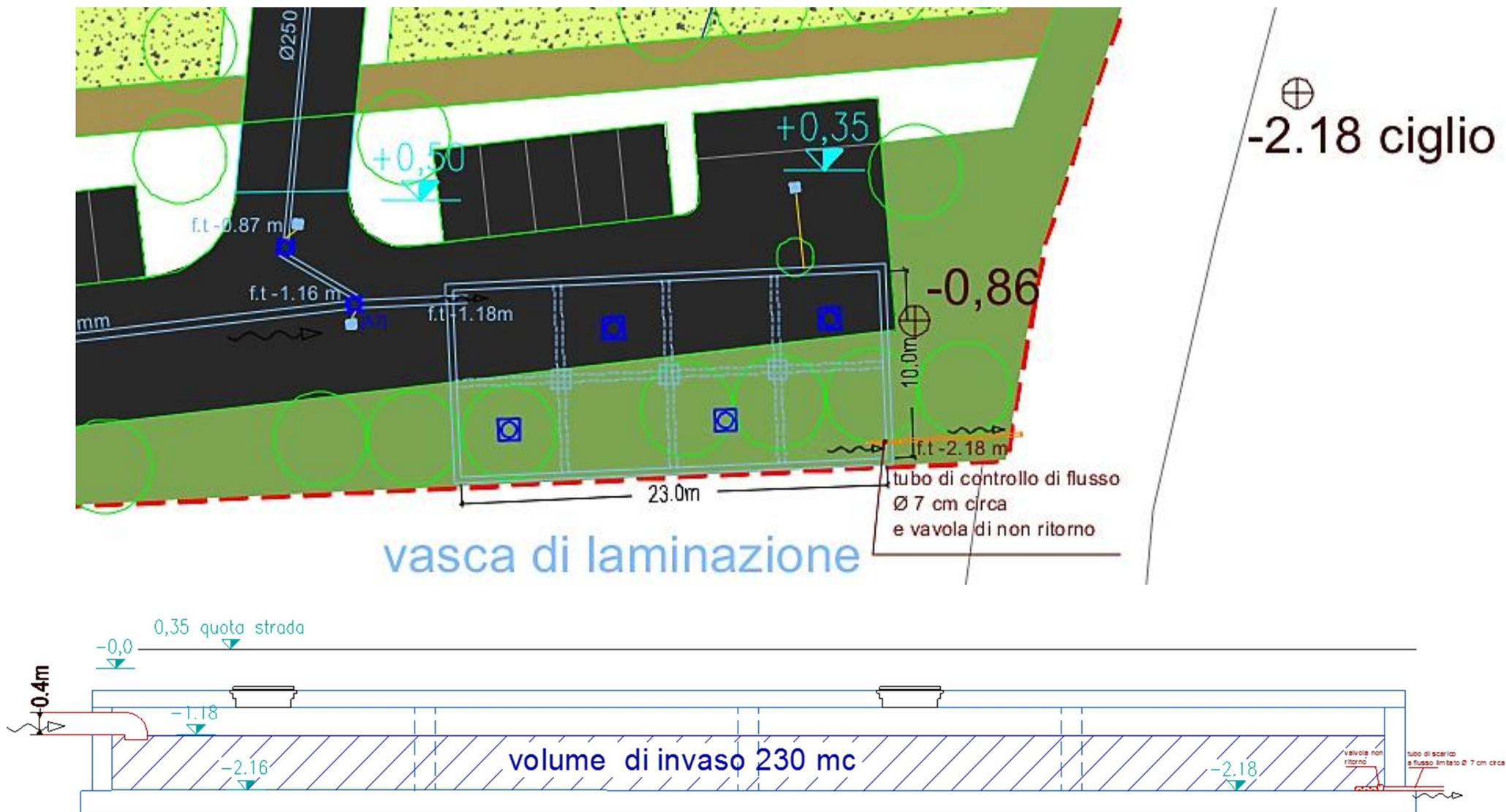
Figura 4: dettaglio con planimetria della vasca di laminazione e dello scarico. Scala 1: 300. In basso sezione indicativa della vasca di laminazione in scala 1: 100.
